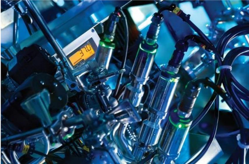
Imagen 1. En un depósito de fermentación, se utilizan múltiples sensores de temperatura.
