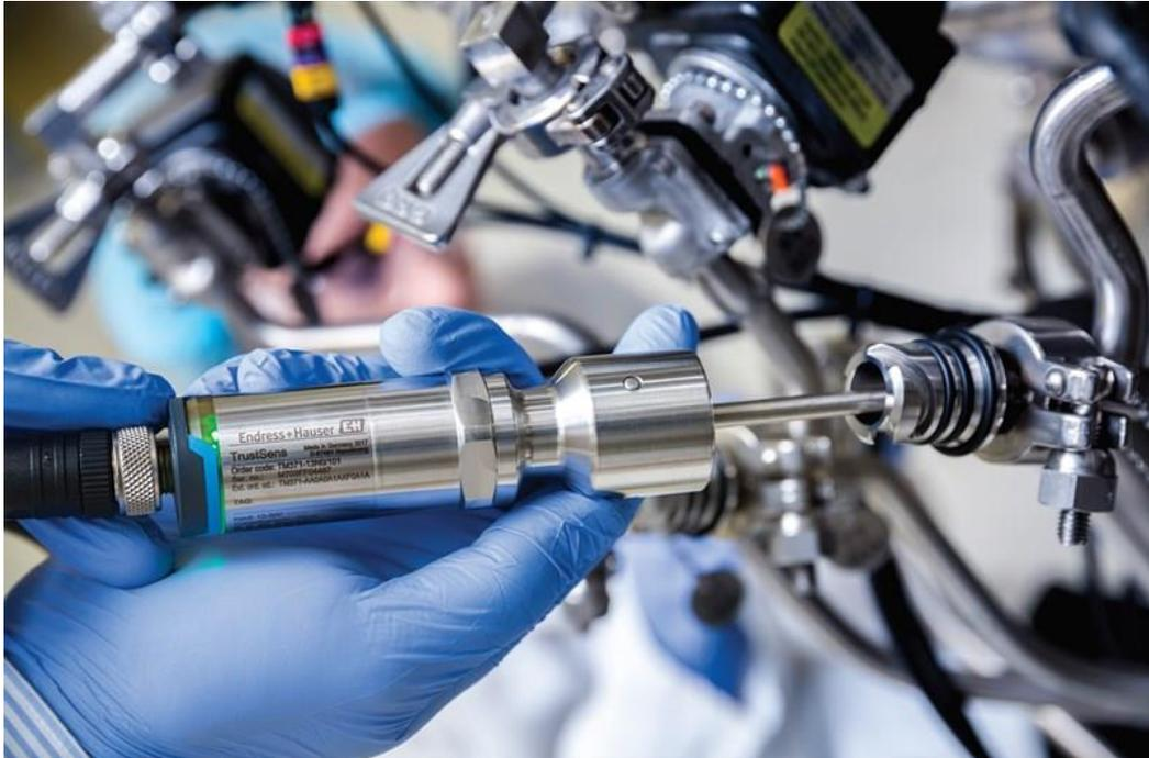
Imagen 5. La opción de cuello *QuickNeck*<sup>®</sup> de Endress+Hauser permite al sensor ser extraído sin necesidad de desconectarlo ni mecánica ni eléctricamente.
